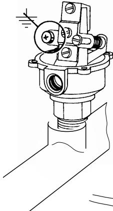
Desenroscar los cuatro tornillos de fijación y levantar la tapa.
