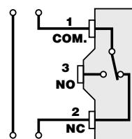
Einsatz des Strömungswächters zum Einschalten eines Geräts **bei Fehlen von Durchfluß**
